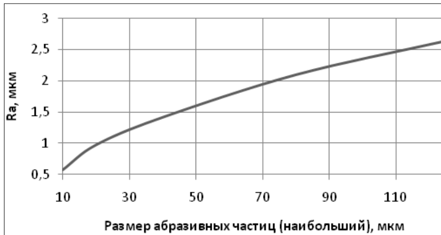
Рисунок 5 Зависимость шероховатости поверхности от размера абразивных частиц, \sigma_B = 620/575 МПа, T = 20 с
